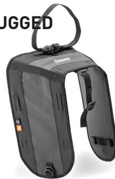
**IT** → Base universale AV00 consente di montare le borse AV01 e AV02 come bagaglio laterale o borse da sella, questo sistema fornisce una soluzione di trasporto leggera e pratica per moto off-road senza perforare la carrozzeria della moto.
