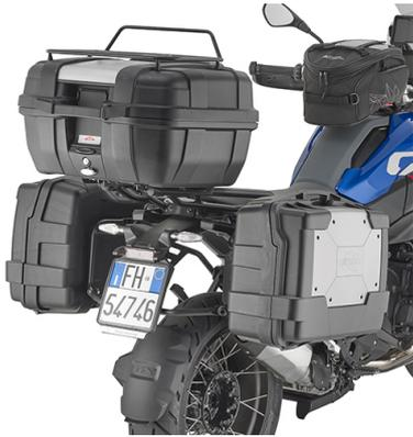
**KLO5143MK** Portamaletas lateral específico KL ONE-FIT configurado para maletas MONOKEY®
