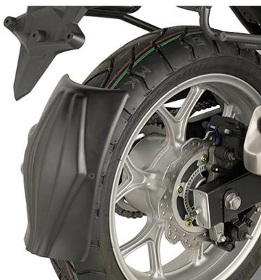
**RM1146KITK** Kit específico para el montaje del salpicadera posterior KRM01, KRM02
