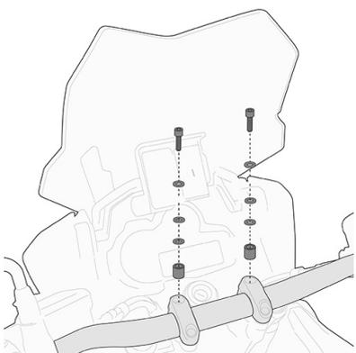
**05SKITK** Kit específico para el montaje del Smart Bar KS900A
